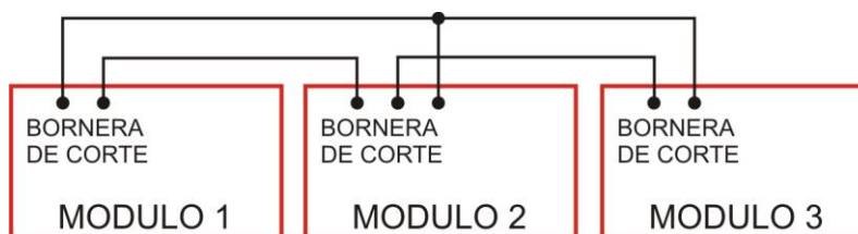
Gráfico 4 – Conexión de lazo en estabilizadores modulares para corte total.
